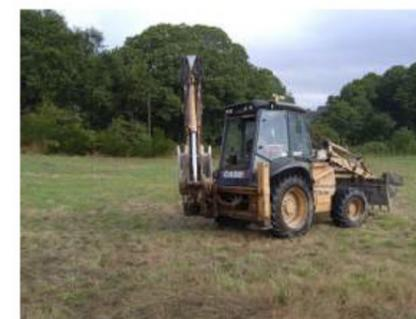
Figura 3.- Retroexcavadora mixta CASE 590 ST empleada en la realización de las calicatas
