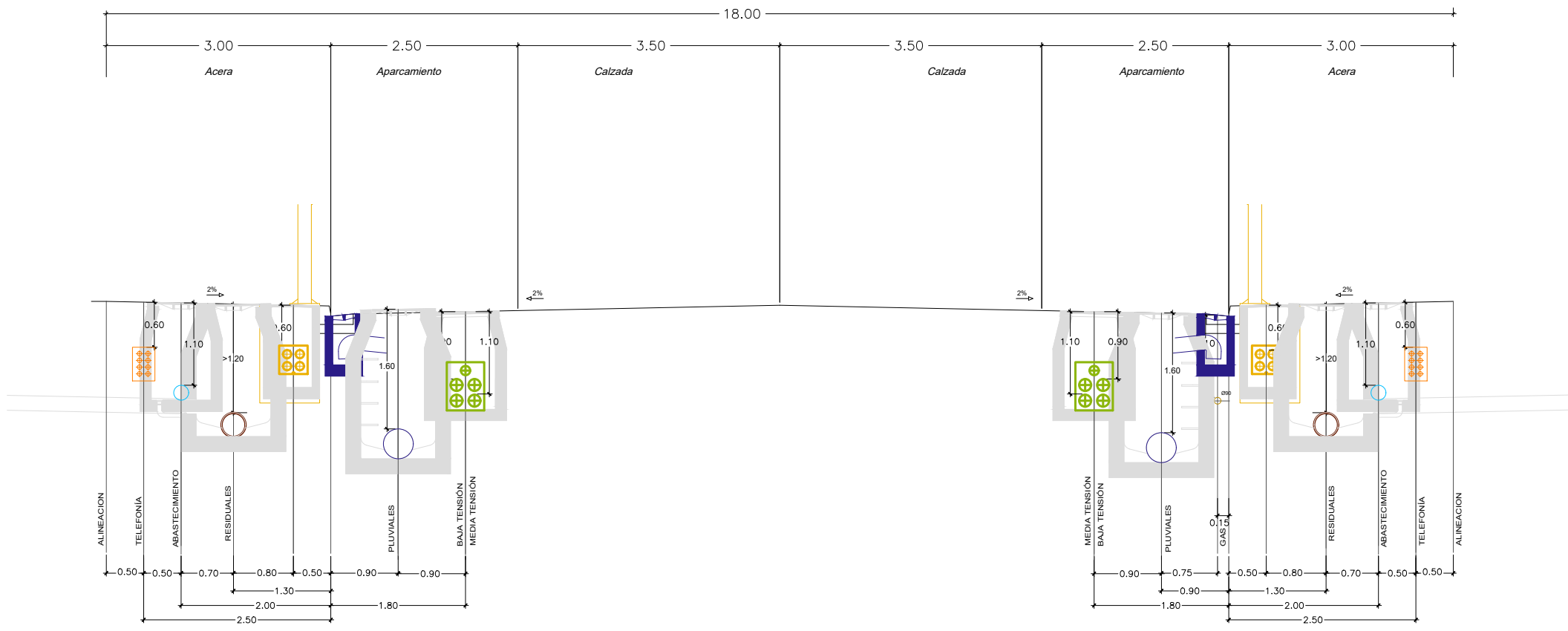
Sección tipo de servicios para viales 20 y 30
